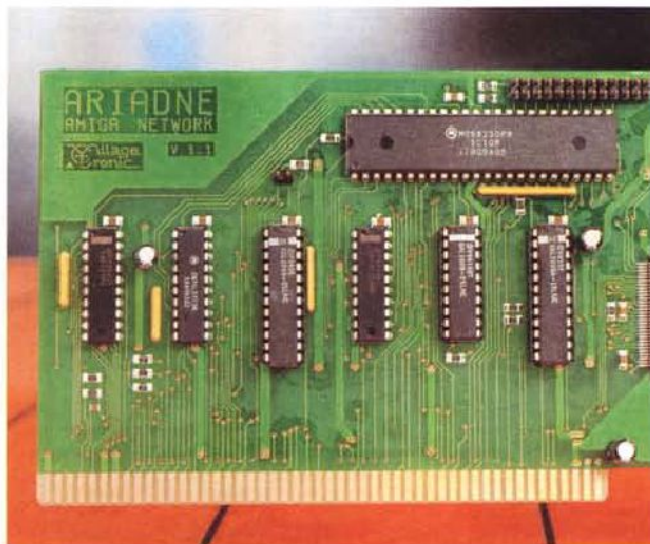
Il connettore per il bus Zorro II e la logica di controllo. Si noti in alto il microcontroller MC68230 e il connettore per la seconda porta parallela.
